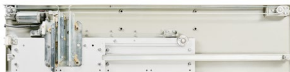
Механізм приводу дверей кабіни DL (SO). Електропривід живлення 24 В; контроль зусилля стиснення між стулками дверей.
